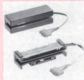
Die Durchzugsleser sind sehr kompakt gebaut und werden mit 5V Gleichspannung gespeist. Die Zuverlässigkeit beträgt 1:1000 und die Lebensdauer ist grösser als 300 000 Zyklen. Anwendungen finden die Leser bei Identitätskartenprüfgeräten, POS-Terminals, Kreditkarten-Terminals, Computerterminals usw.
