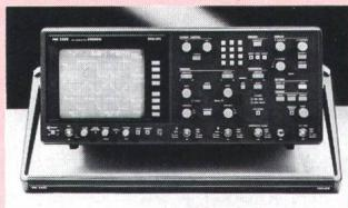
triebsarten und ext. Eventtrigger sind ebenso einfach zu wählen wie die Manipulationen von aktuellen und gespeicherten Signalen in beiden Achsen. Mit dem Speicher für 77 Frontplatteneinstellungen können unverlierbar ganze Messsequenzen auf Abruf bereitgehalten werden.
