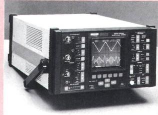
wohl periodische als auch einmalige Vorgänge in seinen Speichern. Die absolute Speichertiefe beträgt 4K im Zweikanal- und 8K im Einkanalbetrieb. Die aufgezeichneten Signale und die Betriebsparameter werden in nichtflüchtigen Speichern abgelegt. Die Autoscope-Funktion bestimmt die automatische Zeitablenkung und die Eingangsempfindlichkeit entsprechend den vorhandenen Signalwerten.
