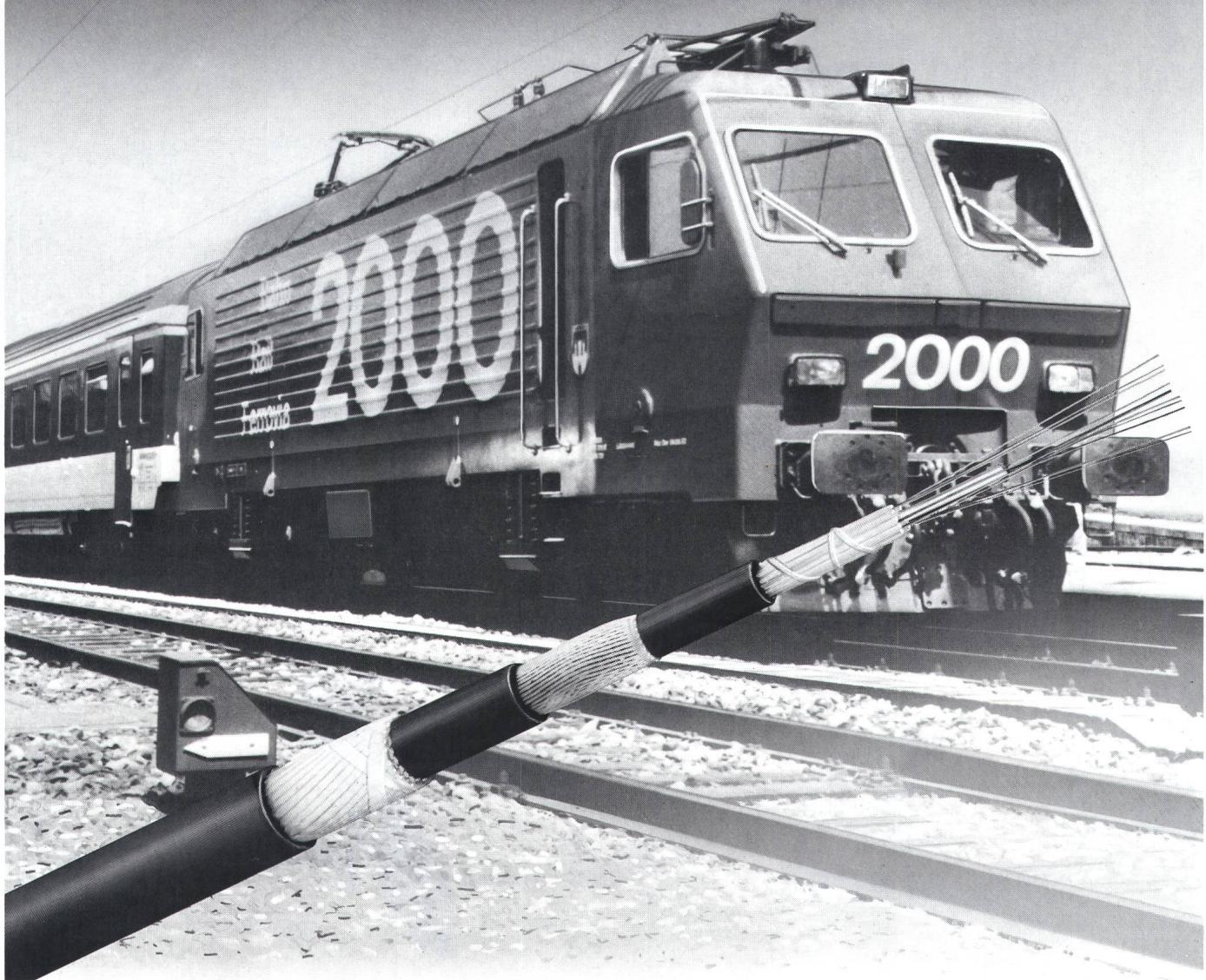
Entlang der Schienen in einer störbeeinflussten Umgebung verlegt, sind Bahnkabel für Nachrichtenzwecke den vom Schienenverkehr herrührenden elektromagnetischen Einwirkungen ausgesetzt.
