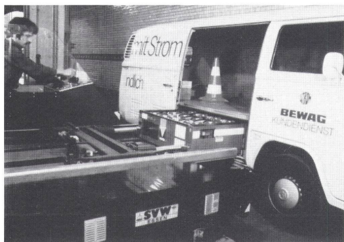
Figur 7 Der Batteriewechsel erfordert entsprechende Einrichtungen
