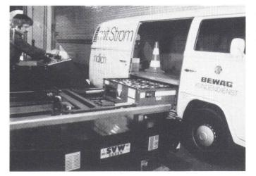
Figur 7 Der Batteriewechsel erfordert entsprechende Einrichtungen
