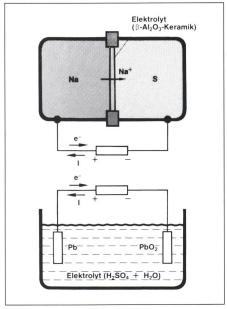
Figur 1 Hochenergiebatterie (oben) und Bleibatterie (unten), Prinzip
