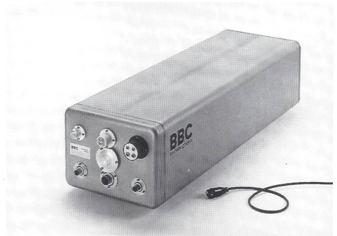
Figur 3 Hochenergiebatterie (265 kg, 250 dm 3 , 32 kWh, 50 kW)
