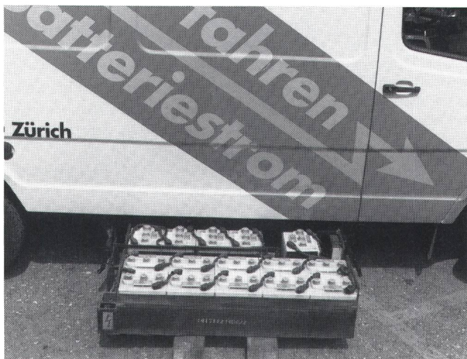
Figur 7 Antriebsbatterie (eine Hälfte) für Mercedes-Transporter 307 E, gesamte Batterie 180 V, Energieinhalt 34,2 kWh (5 h)
