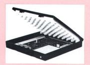
und unten mit antistatischem, korrosionsfreiem Polyurethan-Schaumstoff ausgelegt. Federweich eingebettet, können auch harte Schläge den Platinen nichts anhaben. Am vormontierten Druckknopf lassen sich die Behälter zusätzlich erden. Die Transportbehälter sind in den Grössen 25×20×3 cm,  $30 \times 23 \times 3$  cm sowie  $45 \times 43 \times 5$ cm erhältlich und eignen sich besonders für Europa-, Doppel-Europa- und übergrosse (3M[Schweiz] AG, Platinen. 8803 Rüschlikon)
