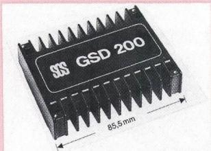
TTL/CMOS kompatibel. Der Motorstrom ist geshoppt und bis 2 A programmierbar. Der Spannungsbereich liegt zwischen 10 und 46 V. Weitere Funktionen wie Synchronisation, Home-Position-Erkennung und Übertemperaturschutz vervollständigen die Ausstattung des Moduls.
