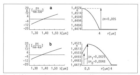
Figure 2 Déplacement du zéro de dispersion chromatique dû à la présence d'un trou central
