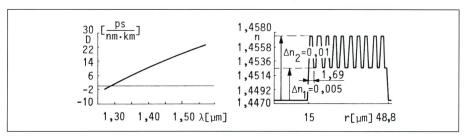
Figure 6 Dispersion chromatique d'une fibre de Bragg
