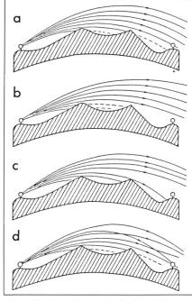
Figur F2 Strahlenverlauf bei typischen troposphärischen Brechungseffekten
