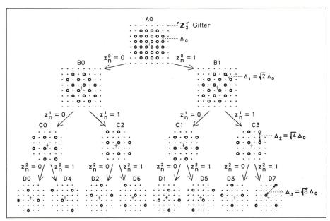
Figur 6 Set-Partitioning, gezeigt am Beispiel einer 32CROSS-Signalkonstellation
