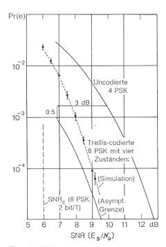
Figur 4 Wahrscheinlichkeit von Fehlerereignissen Pr(e) als Funktion des Signal-Geräusch-Abstandes  $SNR(E/N_0)$  für uncodierte Vierphasenmodulation (4PSK) und trellis-codierte Achtphasenmodulation (8PSK) mit vier Codezuständen
