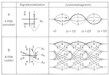
Figur 2 Signalkonstellation und Zustandsdiagramm a uncodierte Vierphasenmodulation (4PSK):  $\Delta_0 = \sqrt{2} = d_{\rm free}$  b trellis-codierte Achtphasenmodulation (8PSK) mit vier Codezuständen:  $\Delta_0 = 2 \cdot \sin(\pi/8)$ ,  $\Delta_1 = \sqrt{2}$ ,  $\Delta_2 = 2 = d_{\rm free}$
