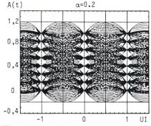
Figur 8 Augendiagramm 64 QAM 8-Stufen-Pulstransienten am Eingang des I- bzw.
