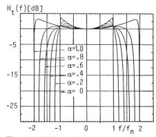
Figur 6 PSK- und QAM-Filterfunktionen
