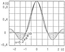
Figur 7 Nyquist-Einzelimpulse UI Unit Interval
