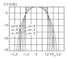
Figur 5 PSK- und QAM-Leistungsspektren am Regenerator
