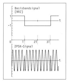
Figur 1 2PSK-Modulation im Zeitbereich
