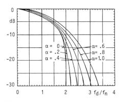
Figur 9 Nachbarkanalunterdrückung am Regeneratoreingang
