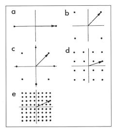
Figur 2 Phasenvektordiagramme für PSK/QAM-Modulationsarten
