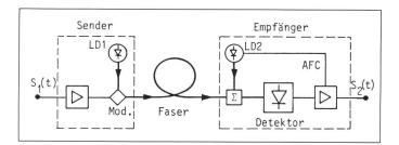
Figur 5 Kohärentes digitales faseroptisches Übertragungssystem
