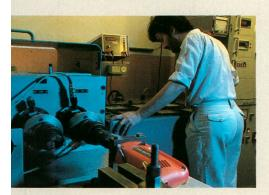
Essai d'échauffement d'une perceuse
