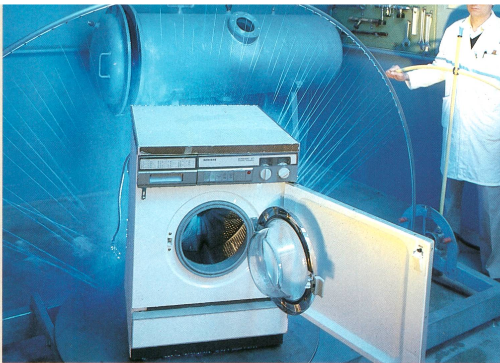
Essai de la protection contre les projections d'eau d'une machine à laver
