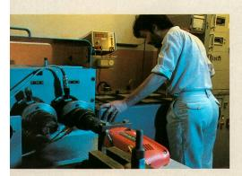
Erwärmungsmessung einer Handbohrmaschine
