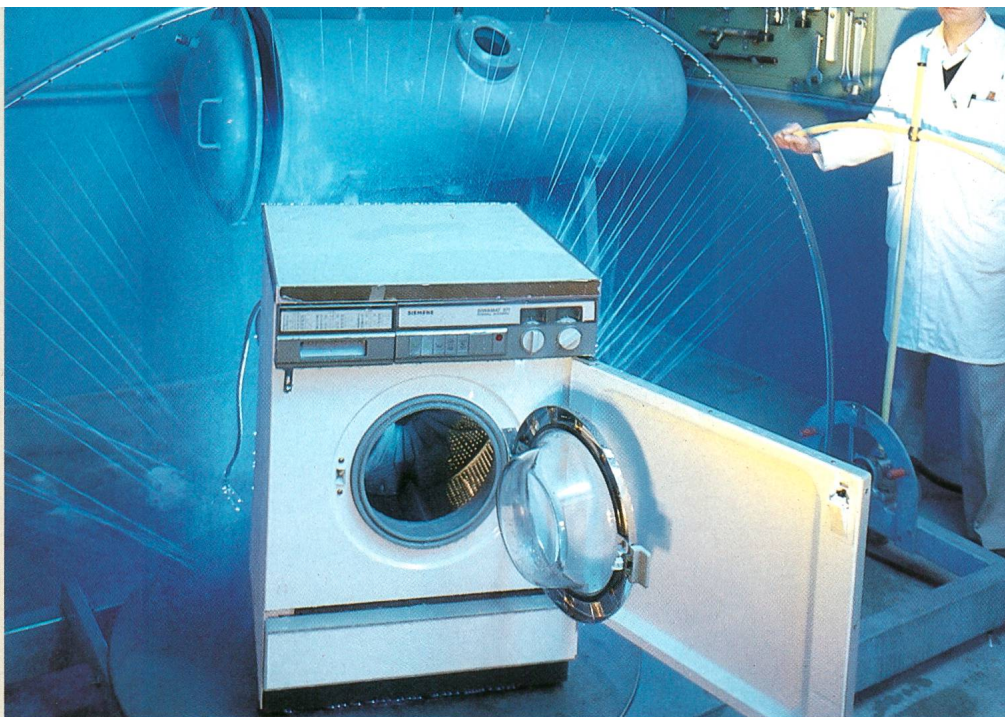
Spritzwasserprüfung einer Waschmaschine
