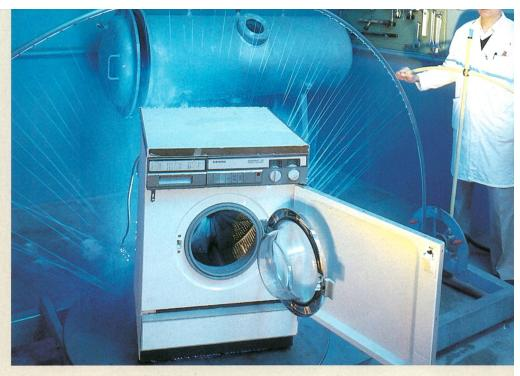
Spritzwasserprüfung einer Waschmaschine
