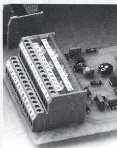
rasse wird durch zwei mit den Klemmen verzapfbaren Seitensteile gestützt.
