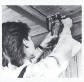
Motornennleistung 620 W. Die Späne werden in einen Staubsack abgesaugt. Eine Spindelarretierung erlaubt einen schnellen Fräserwechsel, die axiale Feineinstellung im Bereiche von 4,5 mm eine präzise Anpassung an die Werkstückdicken.
