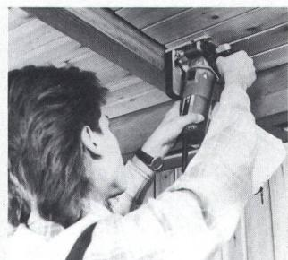
Motornennleistung 620 W. Die Späne werden in einen Staubsack abgesaugt. Eine Spindelarretierung erlaubt einen schnellen Fräserwechsel, die axiale Feineinstellung im Bereich von 4,5 mm eine präzise Anpassung an die Werkstückdicken.
