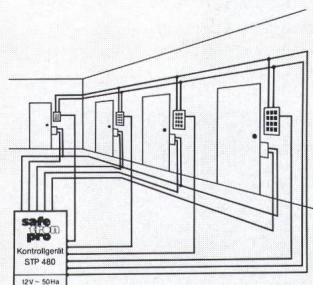
eine Tastatur, über welche ein Zahlencode eingegeben und dadurch der Türöffner zum Auslösen gebracht wird. Pro Tastatur können 10 verschiedene Zahlencodes variabler Länge (1 bis 8 Stellen) programmiert und gespeichert werden. Diese Codes gehen bei einem Netzunterbruch nicht verloren. Nach Eingabe mehrerer falscher Codes (Anzahl wählbar) spricht ein Alarmausgang an, der z.B. auf eine zentrale Alarmanlage geschaltet werden kann. Die
