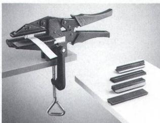
zur Verfügung. Die auswechselbaren Schneid- und Anschlagteile erlauben die Aufnahme von Kabel bis 64polig und Stecker von 6- bis 64polig. Das Werkzeug kann an einem Tisch befestigt oder freihandig benutzt werden. Lieferbar in einem Tragkoffer: Gewicht 2,5 kg.
