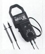
che, mit einer Hand bedienbare Stromzange ist auch für Gleichströme geeignet und misst mit einer Genauigkeit von 0,5/1% + 1 Digit. Die Messwerte lassen sich auf der 3½stelligen LCD-Anzeige mit 13 mm hohen Ziffern ablesen. Ein Anschluss für ein Oszilloskop komplettiert die Einsatzmöglichkeiten des MX 1200.
