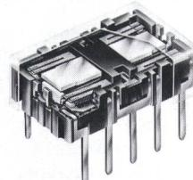
in einer monostabilen und zwei bistabilen Versionen lieferbar. Der Schalteistungsbereich geht von 10<sup>-9</sup> bis 100 W/60 VA; die Ansprech-/Betriebsleistung beträgt 56/100mW, mit 2 Umschaltkontakten. Die niedrige Bauhöhe erlaubt eine hohe Packungsdichte. Das DIL-Gehäuse eignet sich für den Anschluss an 10polige Sockel. Eine Ausführung in SM-Technik ist in Vorbereitung.
