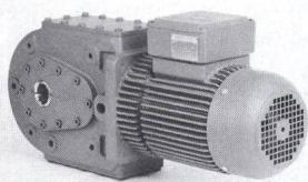
Getriebemotoren (Bild) sind abtriebsseitig mit einer Hohlwelle bestückt und können einfach auf die anzutreibende Welle aufgesteckt werden. Fussplatten, Fundamente und Ausrichtarbeiten entfallen; es muss lediglich das Reaktionsmoment abgestützt werden. Für andere Antriebsaufgaben dienen Trommel-, Schnecken-Getriebemotoren. Bei ihnen ist der Getriebemotor in die Antriebstrommel eingebaut. Der Antrieb benötigt so ein Minimum an Platz.
