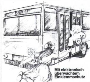
setzbar bei -20 bis +70 °C) schützen vor Verletzung und Beschädigung bei gesicherten Maschinen, Hebebühnen, Tür- und Toranlagen, Regalen, Fahrzeugen, Robotern usw. Aber auch Kabinenbesetzungskontrolle bei Aufzügen, Zutrittskontrolle, Einbruchschutz usw. sind mit den Kontaktmaten möglich. Das zugehörige Schaltgerät überwacht die Anlage und zeigt den jeweiligen Schaltzustand an. Die Kontaktstreifen und -matten sind in diversen Abmessungen lieferbar.
