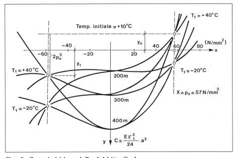
Figur 3 Zustandsgleichung als Parabel dritten Grades Seildaten wie Figur 4; ohne Zusatzlast ( $\gamma_0 = \gamma_1$ ) Kurvenschar für T = 40 °C und T = -20 °C Spannweiten 200, 300, 400 m
