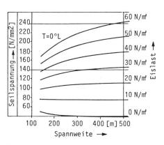
Figur 5 Spannungstabelle mit Zusatzlast
