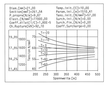
Figur 4 Spannungstabelle ohne Zusatzlast
