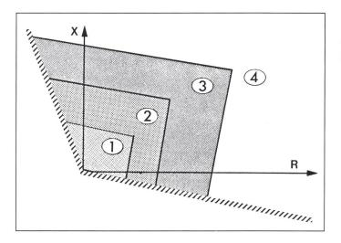
Figure 1 Relais à caractéristique polygonale 1...4 Plages de réglage
