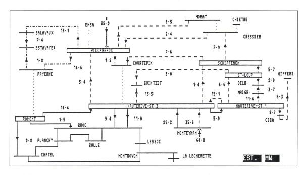
Figure 3 Image du réseau 65 kV Les chiffres indiquent les puissances actives transitées.
