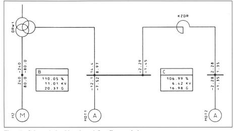
Figur 5 Schematischer Netzplan mit Lastflussergebnissen
