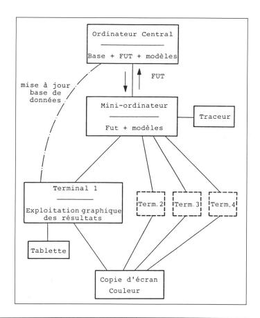
Modèles sur le mini-ordinateur: Le FUT est transféré sur le mini-ordinateur aussitôt après l'extraction, et les modèles sont exécutés localement sur cette machine. Cette utilisation n'est sans doute pas possible pour les grands modèles probabilistes de planification très gourmands en temps de calcul, mais convient bien pour la planification des réseaux régionaux.
