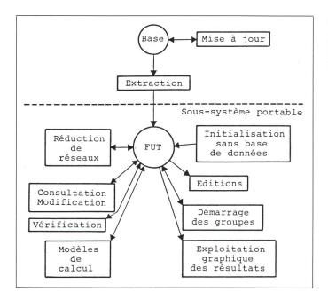
Figure 1 Architecture logicielle du système informatique PLATINE
