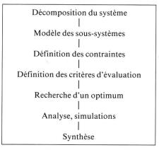
Tableau I Méthodologie pour l'analyse d'un système électrique
