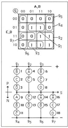
Figure 2 Exemple de synthèse séparée d'une porte logique CMOS
