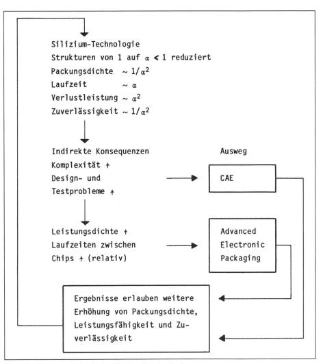
Figur 6 Synergieeffekte in der Elektroniktechnologie α Linienbreite, bezogen auf eine frei gewählte Standardlinienbreite
