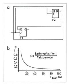
Figur 9 Anteil der Leitungslaufzeit als Funktion der Taktperiode
