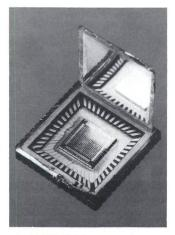
Figur 5 LCC-Gehäuse
