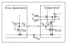
Figur 4 Beispiel für analoge Standardzellen
