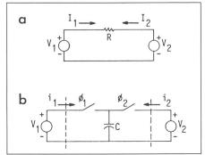
Figur 1 Switched Capacitor - Ausführung eines kontinuierlichen Widerstandes
