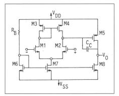
Figur 3 Schaltschema eines ungepufferten CMOS-Operationsverstärkers mit einem n-Kanal-Transistorpaar
