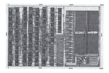
Floorplaning des Chips gewisse Vorteile. Eine Vielzahl von Programmen, die sich jedoch alle zurzeit noch in der Entwicklungsphase befinden, versuchen parametrisierbare Makroblöcke zu erstellen. Diese erlauben eine grössere Flexibilität für die Spezifikation der Blöcke.
