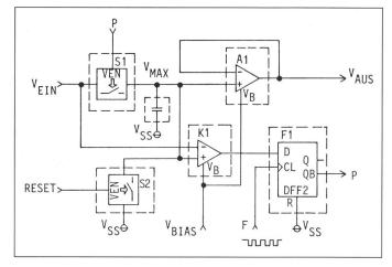
Figur 7 Layout eines 8-bit-A/D-Wandlers
