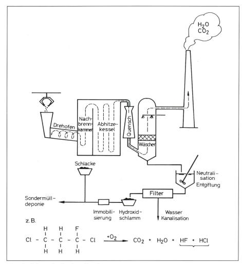
Figur 3 Schema der Sondermüllverbrennung
