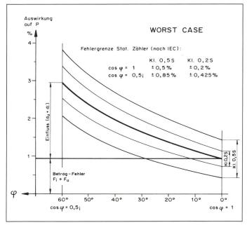
Figur 8 Gesamtauswirkung auf Leistungsmessung bei 5% Last
