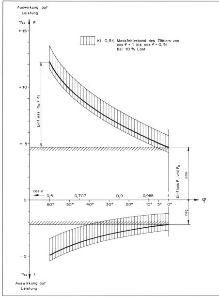
Figur 13 Gesamtauswirkung auf Leistungsmessung
