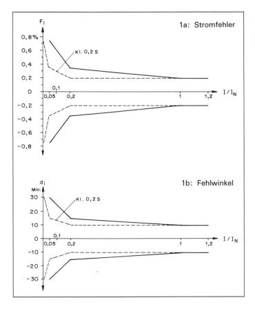
Figur 1 Fehlergrenzen der Stromwandler Klasse 0,2
