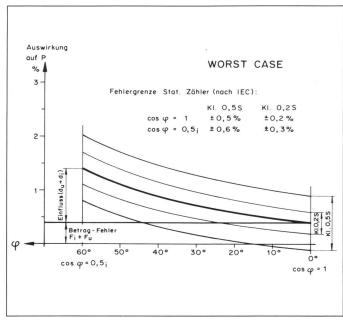
Figur 9 Gesamtauswirkung auf Leistungsmessung bei 100% Last
