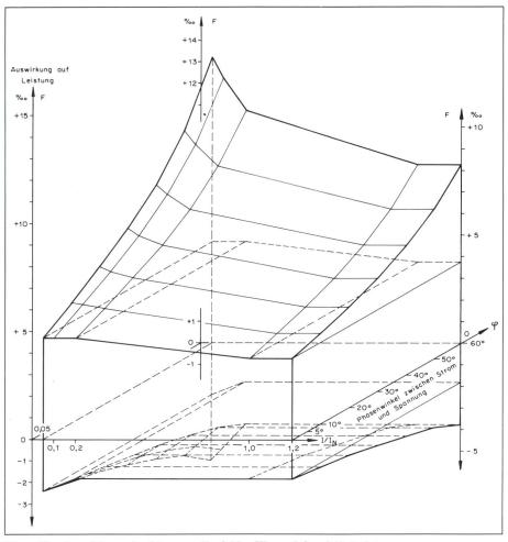
Figur 12 Auswirkung der Messwandlerfehler Klasse 0,2 auf die Leistungsmessung Strom- und Spannungswandler sind mit ¼ Nennbürde belastet
