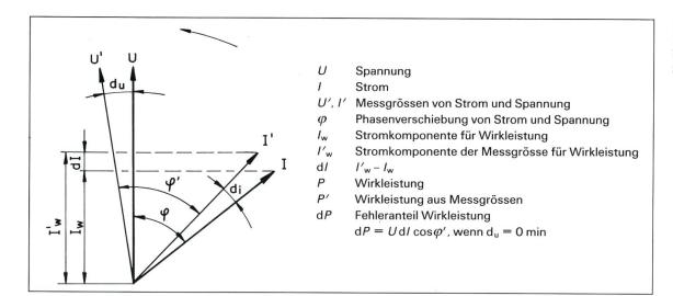
Figur 6 Fehlwinkel-Einfluss bei nacheilendem Strom
