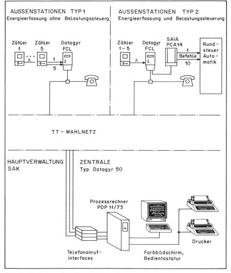
Figur 3 Blockschema des rechnergesteuerten Systems
