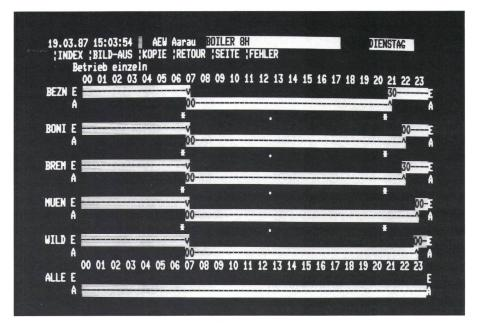
Figur 6 Zentrales, flexibles Rundsteuer-Tagesprogramm
