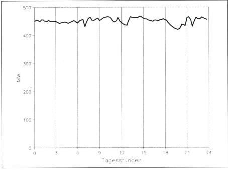
Figur 2 Tagesbelastung AEW an einem Spitzenbelastungstag im Januar 1987
