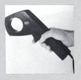
Analogausgang direkt proportional zum Strom oder zur Wirkleistung. Er ist vom Messobjekt isoliert und dient zum Anschluss eines Multimeters oder eines Oszilloskopes. Zum Lieferumfang gehört auch ein solider praktischer Tragkoffer. Vorteile sind auch: grosse Öffnung der Zange, praktischer Pistolengriff, 100 Std. Betriebsdauer mit einer Batterie 9 V, hohe Messgenauigkeit, Anzeige: Batterie ersetzen.
