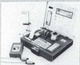
bräuchlichen Energien. Das Gerät ist einfach und ohne Eingriffe in die vorhandenen Energieverteilssysteme an das zu untersuchende Netz anzuschliessen. Der Analytator liefert exakte Protokolle und aussagefähige, grafische Verbrauchsprofile über Elektro-, Gas-, Öl-, Wasser- oder Wärmeverbrauch. Er dient zur Beurteilung der Energiekosten, zur Aufdeckung von Verbrauchsspitzen und zur Empfehlung von kostensenkenden Massnahmen.
