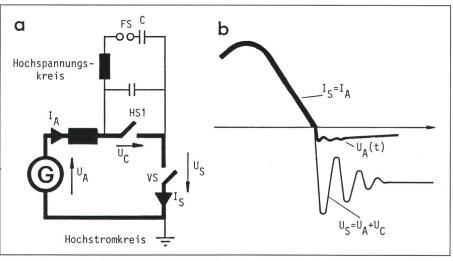
Figur 8 Spannungsüberlagerungskreise (a) mit schematischen Strom- und Spannungsverläufen (b)
