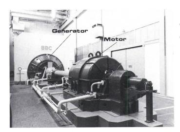
Figur 5 Kurzschlussgenerator (3,8 GVA) mit Antriebsmotor (2 MVA)
