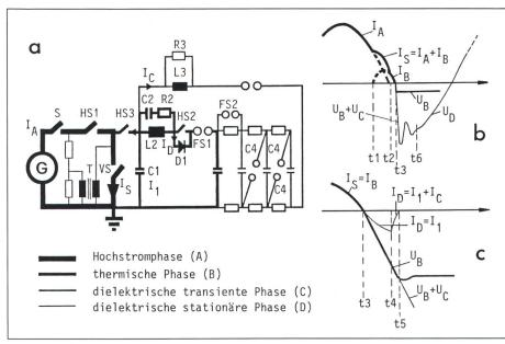
Figur 11 Prinzipschema der Modularen Mehrkreissynthetik (a) mit den Strom- und Spannungsverläufen (b)
