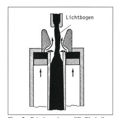
Figur 2 Prinzip eines SF<sub>6</sub>-Blaskolbenschalters
