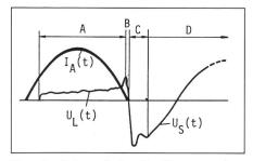
Figur 1 Schematisches Oszillogramm einer Wechselstromunterbrechung
