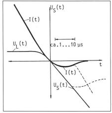
Figur 3 Stromverlauf I(t) und Spannungsverlauf  $U_{\rm S}(t)$  um den Stromnulldurchgang im bzw. über dem Schalter
