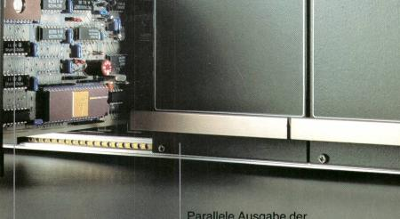
Meßgrößen, Meßbereiche, Kennlinien, Netzart, im Datenspeicher programmiert. Parallele Ausgabe der Meßwerte über maximal 6 Analog-Ausgänge pro Gerät. Beliebige Kombination Meßgröße-Ausgang.
