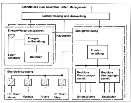
Figur 6 Columbus - Energieversorgungssystem des Versorgungsmoduls
