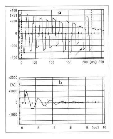
Figur 3 Spannungsverlauf am Stromwandler beim Öffnen eines 420-kV-Trenners
