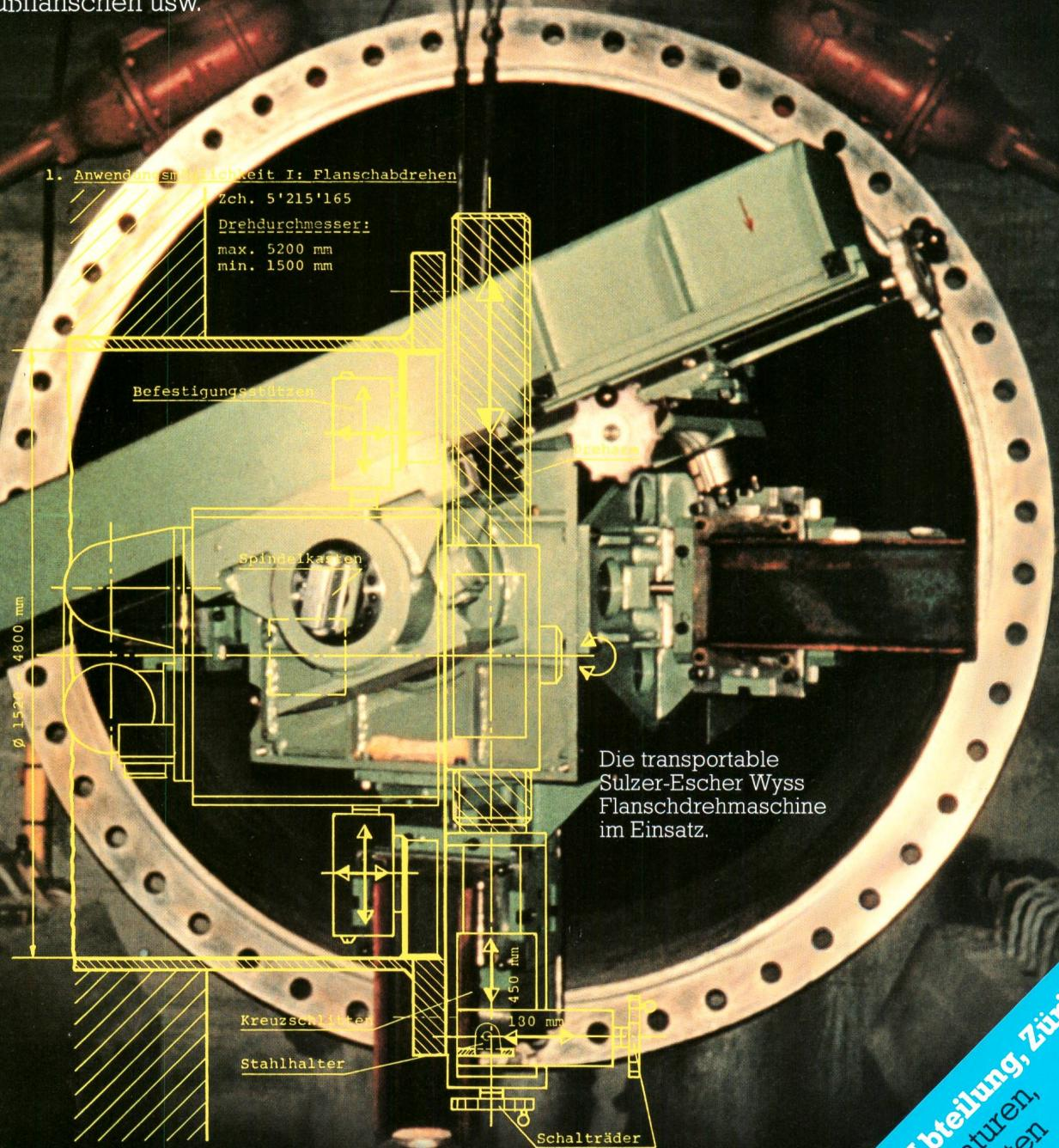
Die transportable Sulzer-Escher Wyss Flanschdrehmaschine im Einsatz.
