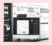
innenliegendes Kassettensystem konzipiert; dies ermöglicht nicht nur den unkomplizierten Papierwechsel, sondern ergibt auch eine extrem flache Frontplatte.
