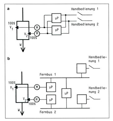
Figur 1 Beispiel: Speisewasserzufuhrregelung
