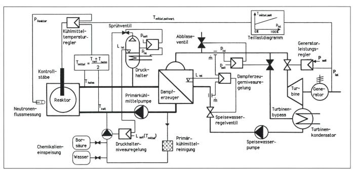
Figur 1 Vereinfachtes Prinzipschema einer Druckwasserreaktoranlage
