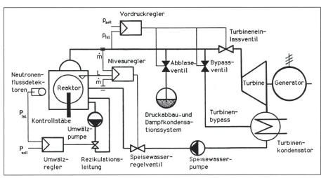
Figur 2 Vereinfachtes Prinzipschema einer Siedewasserreaktoranlage
