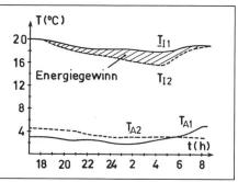
Figur 6 Vergleich der klassischen Nachtabsenkung der Vorlauftemperatur mit dem optimierten Ein- und Ausschaltbetrieb. Zeitverlauf der Gebäudeinnentemperatur bei ähnlichen Aussentemperaturbedingungen
