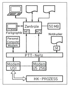
Figur 5 Konfiguration des Leitsystems SICOS 2000
