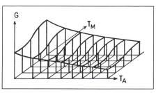
Figur 3 Verteilung der Einschaltgradienten für einen Heizkanal mit 40 Stützwerten
