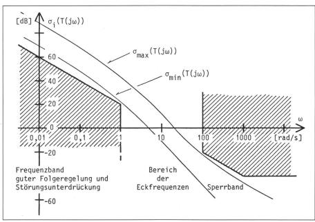
Figur 1 Beispiel einer Spezifikation für die Singularwerte der Kreisverstärkungsmatrix  $T(j\omega)$  eines Mehrgrössen-Folgeregelungssystems mit I-Anteil in der Regelung
