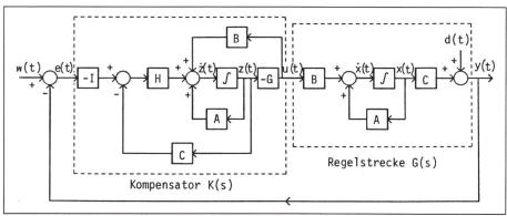
Figur 3 Detailliertes Signalflussbild eines robusten Mehrgrössen-Folgeregelungssystems mit Ausgangsvektor-Rückführung
