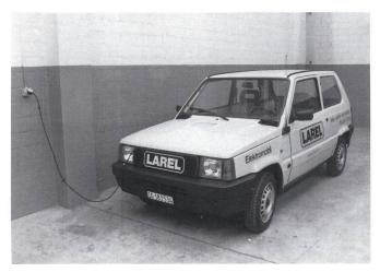
Als Besonderheit verfügt der LAREL über eine Elektrobremse; der Antriebsmotor wirkt beim Schub oder beim Abwärtsfahren als Generator mit Stromrückspeisung in die Batterie. Damit werden eine stromsparende Fahrweise, die zusätzliche Sicherheit beim Abwärtsfahren durch die sehr fein abgestufte Elektrobremse und gleichzeitig weniger Abnützung an den normalen Bremsen erreicht. Der Typ Wil 101 ist mit diversem Zubehör lieferbar wie beispielsweise einer Gasheizung und einem Kilowattstundenzähler.
