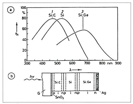
Figur 4 ⓐ Einfluss von Zulegierungen auf die Lage der Energiebandlücken
