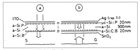
Figur 1 Aufbau amorpher Dünnfilmzellen
