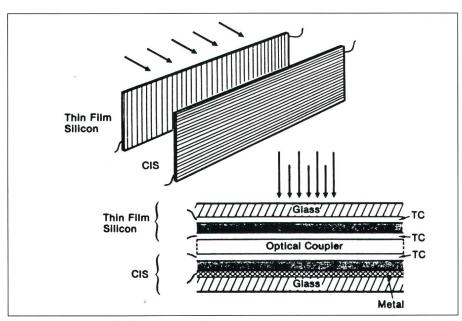
Figur 5 Aufbau der Tandemzellen von Arco Solar
