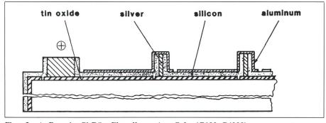
Figur 2 Aufbau eine Si-Dünnfilmzelle von Arco Solar (G100, G4000)
