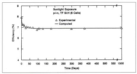
Figur 8 Degradier- und Stabilisierverhalten von Arco-Solar-Si-Dünnfilm-Material. Echte Messresultate seit Januar 1983
