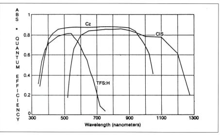
Figur 6 Spektrale Ansprech-Empfindlichkeit von: TFS Dünnfilm-Silizium CIS Dünnfilm CuInSe2
