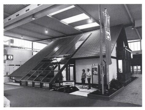
Figur 1 Einfamilien-Musterhaus der Firmen AEG und Okal mit 30 m² Solarzellen. Der Solargenerator besteht aus 48 Modulen und liefert bei optimalen Verhältnissen eine elektrische Leistung von 2 kW.
