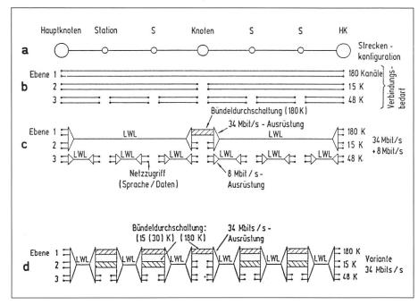
Figur 3 Zuordnung der Funktionsebenen im zukünftigen SBB-Netz
