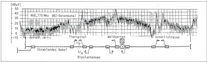
Figur 5 Pegelverlauf und Antennenanlage im Tunnel
