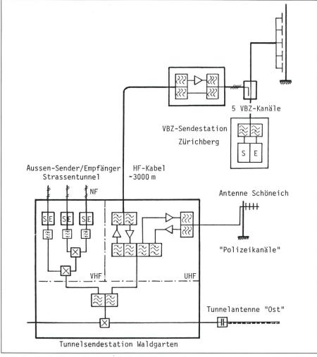
Figur 4 Blockschema der Tunnelfunkanlage
