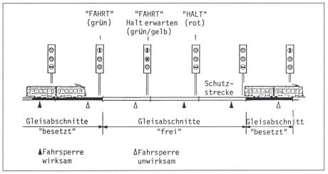
Figur 2 Prinzip der Zugsicherungsanlage im Tunnel
