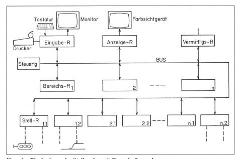
Figur 1 Blockschema des Stellwerkes mit Doppelmikrorechnern
