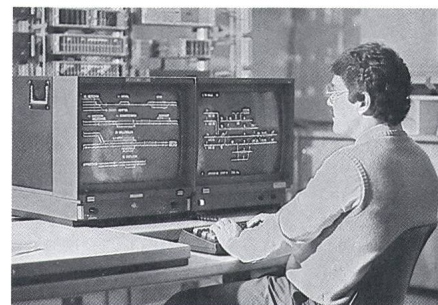
Figur 2 Bedienplatz mit Farbsichtgeräten Übersichtsbild links, Lupenbild rechts
