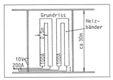
Figur 4 Niedervolt-Bodenheizung als Störquelle
