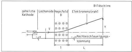
Figur 2 Strahlauslenkung durch die magnetische Induktion B
