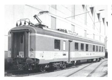
Figure 1 Voiture de mesure des lignes de contact
