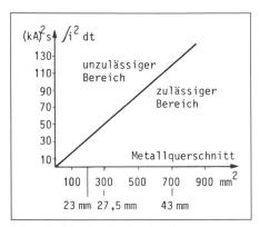
Figur 6 Maximal zulässige Strombelastung von Litzenseilen
