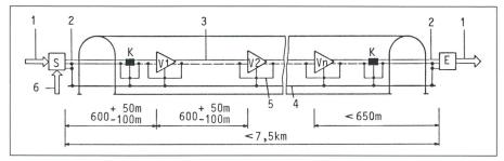
Figur 1 Prinzipaufbau einer Tunnelfunkanlage
