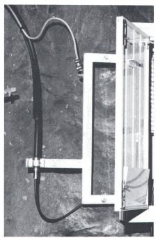
Figur 2 Montagerahmen zu Verstärkerkasten
