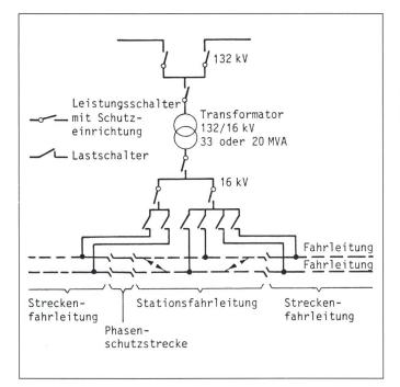
Figur 3 Prinzipschema eines Unterwerkes BLS
