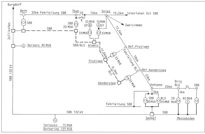
Figur 1 Prinzip der Traktionsenergieversorgung beim BLS-Ausbau auf Doppelspur
