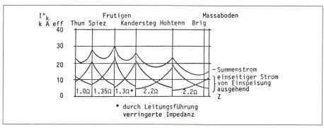
Figur 2 Subtransiente Kurzschlussströme und Impedanzen im Fahrleitungsnetz
