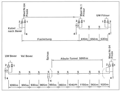
Figur 9 Kabelschema
