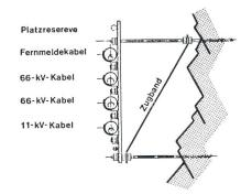
Figur 7 Kabel-Rohrblockanlage im Albulatunnel
